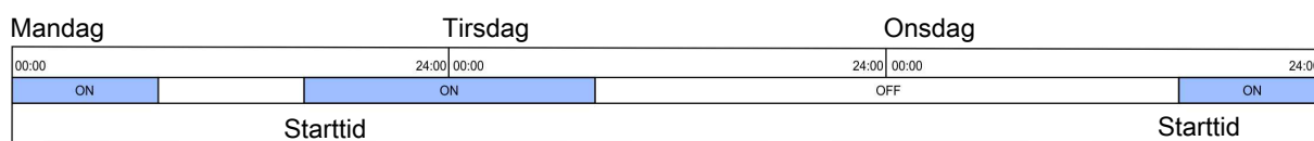
Figur 12: Hvis en ON-tid løber over midnat på et døgn, hvor uret ikke er aktivt, vil funktionen forblive ON, indtil tiden er udløbet.
